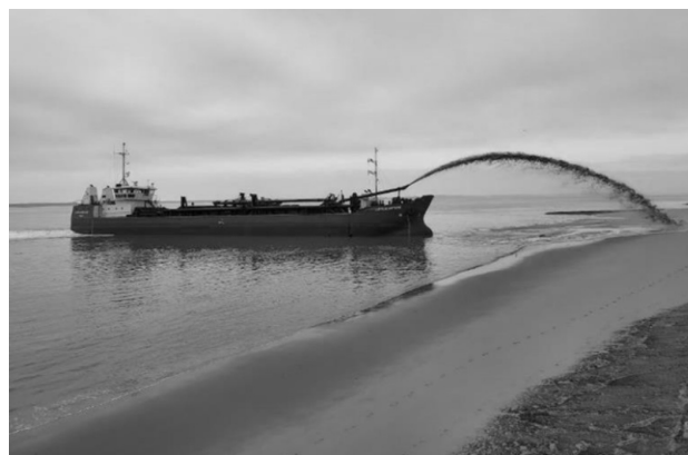
L'imposant navire « Côtes de Bretagne » rejetant du sable prélevé. © Syndicat intercommunal du bassin d'Arcachon
